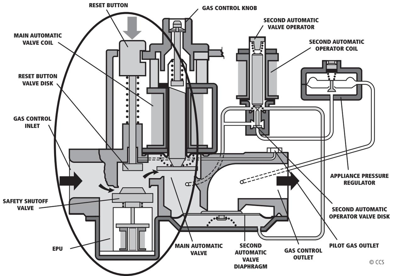
**MILLIVOLT POWERED AUTOMATIC GAS CONTROL VALVE**
