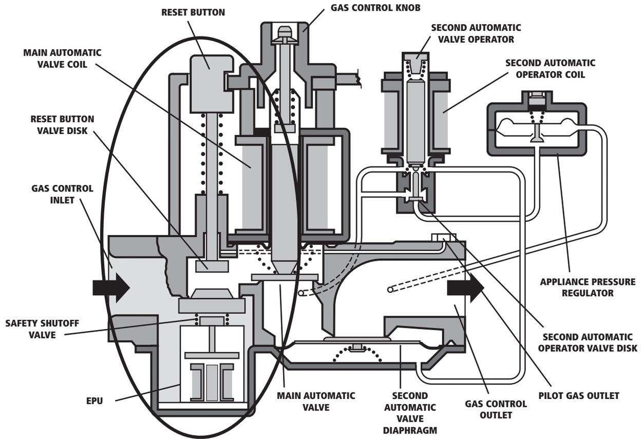
MILLIVOLT POWERED AUTOMATIC GAS CONTROL VALVE
